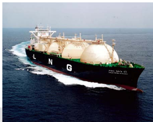
شکل ۳. کشتی حمل ال. ان جی با چهار مخزن کرووی [۱۱].
