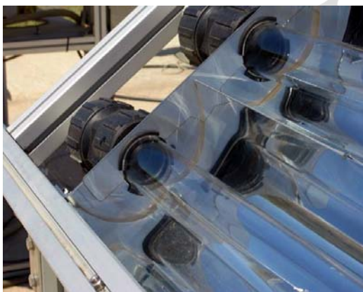
شکل ۱. تصویر رآکتور سه‌می‌وار مرکب خورشیدی، نمای کلی رآکتور (بالا) تصویر صفحات سه‌می‌وار و لوله جاذب قرار گرفته در مسیر کانونی رآکتور (پایین) [۶].
